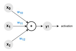
$$\begin{pmatrix} y_0 \\ y_1 \\ y_2 \end{pmatrix} = \begin{pmatrix} w00 & w01 & w02 \\ w10 & w11 & w12 \\ w20 & w21 & w22 \end{pmatrix} * \begin{pmatrix} x_0 \\ x_1 \\ x_2 \end{pmatrix}$$
