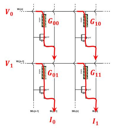
$$\begin{pmatrix} I_0 \\ I_1 \end{pmatrix} = \begin{pmatrix} G_{00} & G_{01} \\ G_{10} & G_{11} \end{pmatrix} \begin{pmatrix} V_0 \\ V_1 \end{pmatrix}$$
